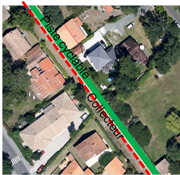
Schémas d'implantations types du collecteur
